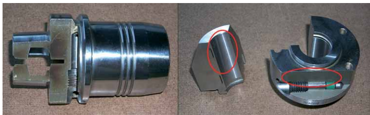
Bild 4: Aufbau eines Hydrodehnspannfutters
