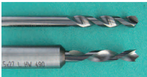
Für Holzwerkstoffe optimierte Bohrer mit 120°-Dachspitze (oben) und mit Flachspitze und Vorschneider (unten)
