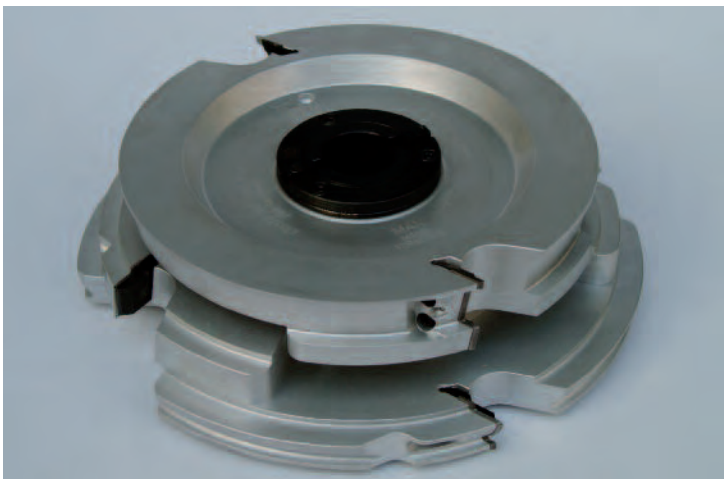
Werkzeugsatz mit Leichtmetall-Tragkörper
