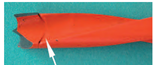
Sichtbare Vertiefungen an der Lötstelle
