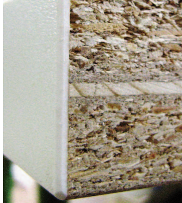
Abb. 8: Schichtaufbau eines Türelementes für modulare Raumtrennsysteme
